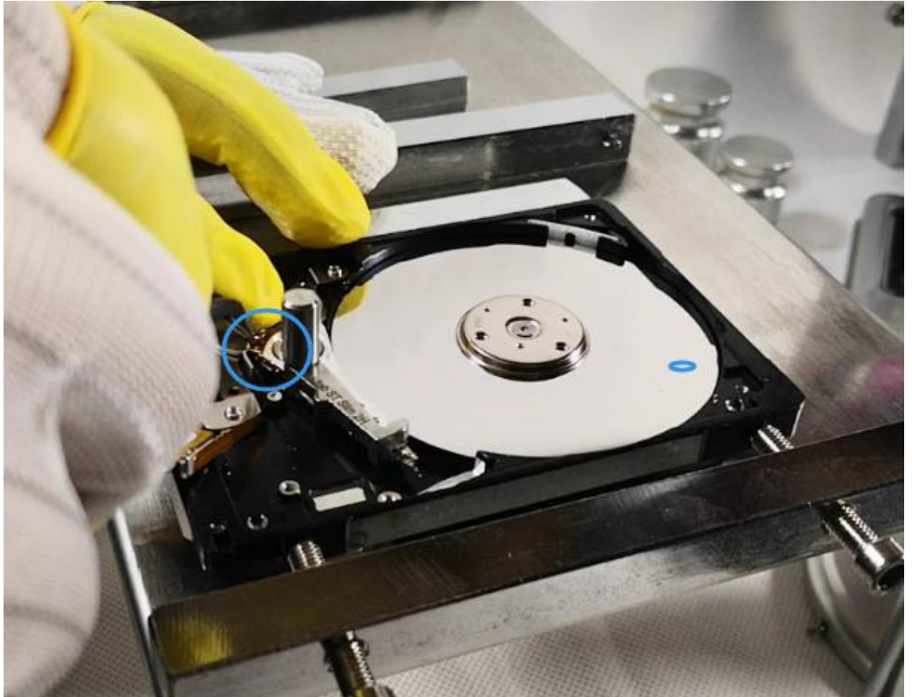
<图十一>可以在镊子夹住那里或者其他小孔，熟练的直接拿工具的手柄
